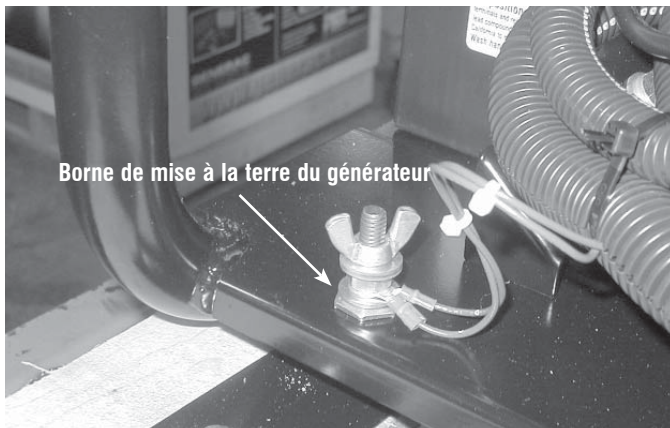
Schéma 15 - Mise à la terre du générateur
