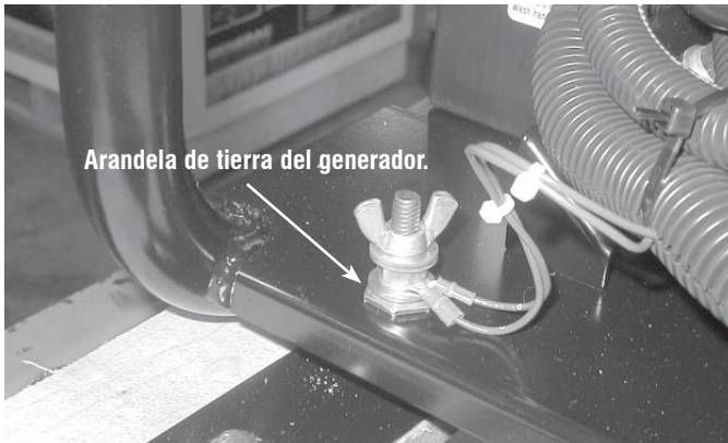
Figura 15 - Conexión a tierra del generador
